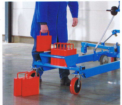
Einzeln herausnehmbare Kontergewichte á 16 kg.
